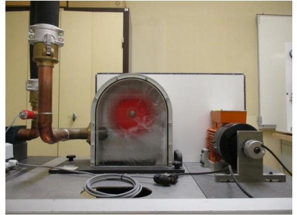
Figure 13 : Fonctionnement de la turbine Pelton
